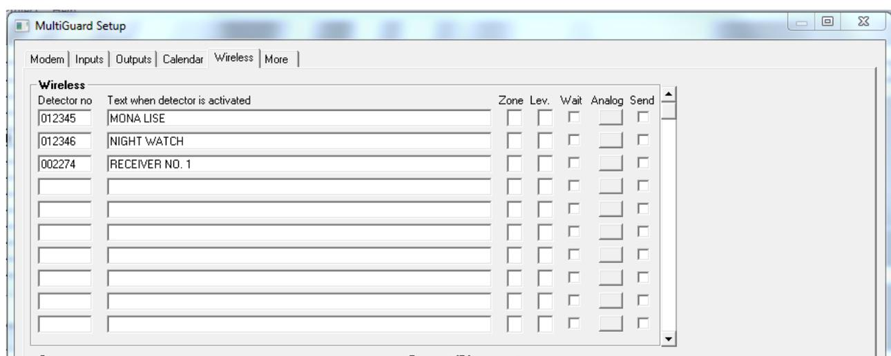
Hvis Piccolo Light er opsat til at overvåge de trådløse detektorer og alarmmodtager og ikke har modtaget signaler i 30 minutter, vil Piccolo Light afgive en 'warning' på den aktuelle enhed. 'Warning' vil blive vist i alarmbilledet og gemt i loggen.
