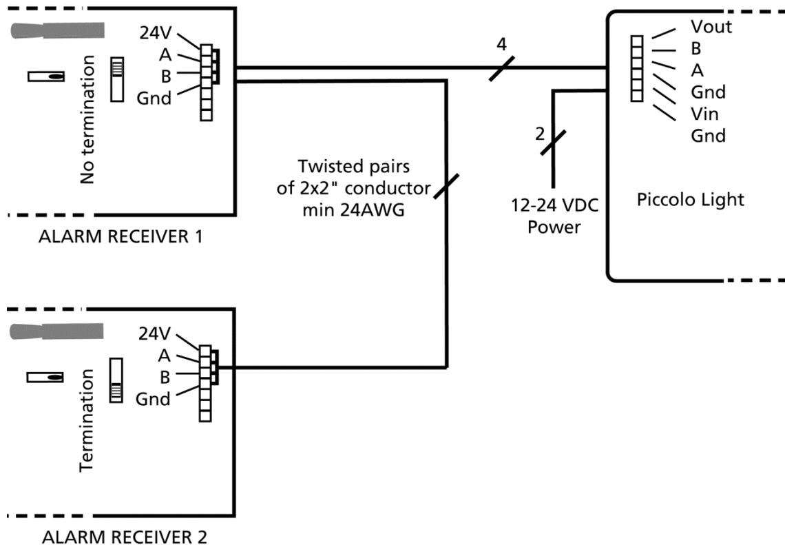
Benyttes eksterne alarmmodtagere i et RS485 bus-system, skal man huske at lave en terminering (modstands-afslutning) på den alarmmodtager, der er længst væk. Dette gøres ved at sætte switchen på printet: Sæt switch i 'Termination'.
