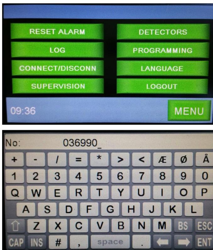
Indtast oplysningerne, der identificerer den enkelte detektor: Monter alle detektorer på de genstande, der skal overvåges.
